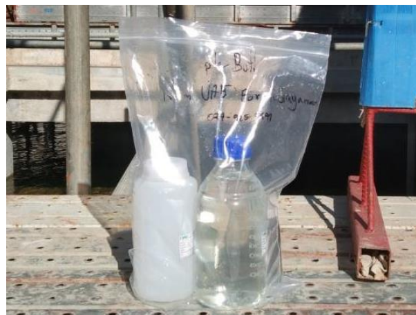
รูปที่ 2-55 ตัวอย่างน้ำจากการทดสอบแรงดันท่อ (Hydrostatic Test)
